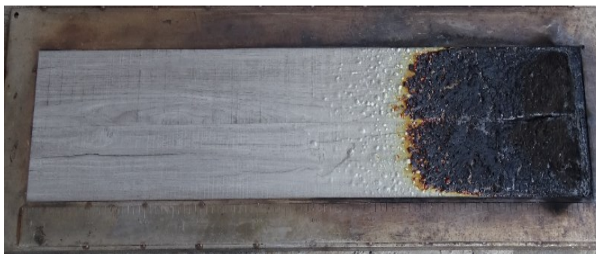
Foto 3 – Material após a realização do ensaio.
